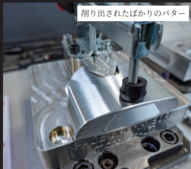
5軸切削機によって削り出される様子
